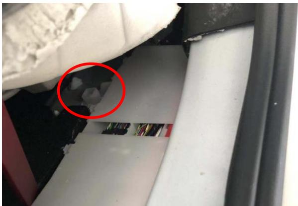
右踏板电机穿线孔 : 使用撬板撬开线槽卡扣 ,
