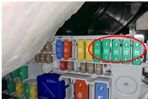
接正极线 : 把取电器插入原保险盒取电 ( 红圈 ), 线接口处固定好 , 防止松动 ; **建议最后连正极取电** ;
