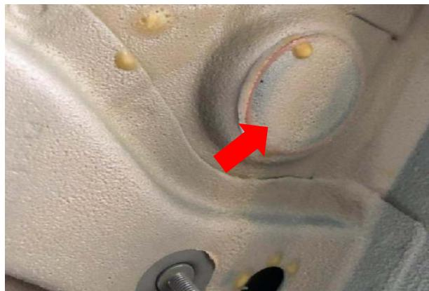
右踏板电机穿线孔 : 电机线由此孔穿过 , **注意不要损伤车身内部的线槽** ;
