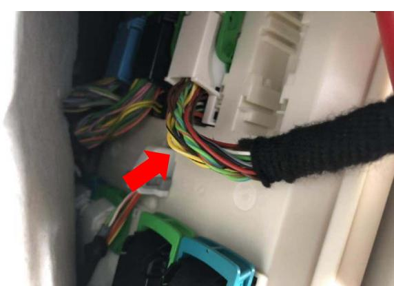
接信号线 : 如图箭头所示为所要连接的信号
