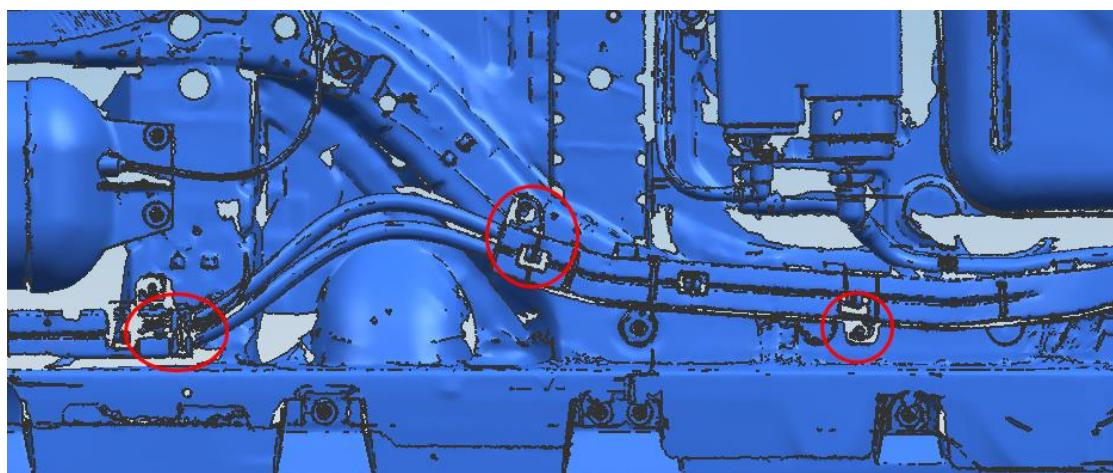
将右前支架安装到如下图的车底盘位置，拆下胶塞，去除孔周围的防水胶，先用 T 型螺栓+塑料卡块卡到车底盘（见下图）（螺母块则直接卡到车底盘），然后用对应弹簧垫、大垫片、螺母（螺母块）装上，将支架连接并拧紧。见下图
