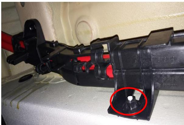
高配车型在穿线时空间相对狭小 , 需要把底盘下的线槽拆下以方便操作 ( 红圈 ); 穿线完成后注意在孔周边打上防水胶 ;
