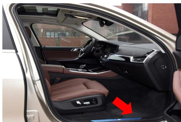
右踏板电机穿线孔：掀起此处垫脚海绵，看到线槽（箭头）
